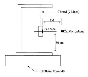
1 METER FROM MICROPHONE TO FAN INTAKE
