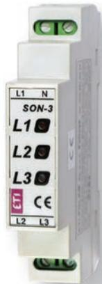
**Применение** - Предназначены для визуального контроля состояния трехфазных сетей. Каждой фазе соответствует один светодиод (L1, L2, L3). В случае пропадания фазы погаснет светодиод который соответствует фазе. При понижении уровня напряжения - яркость светодиодного индикатора слабеет, при полном пропадании напряжения - светодиодный индикатор гаснет. Сигнализатор SON-3ZP информирует о состоянии сети только при нажатии контрольной кнопки.
