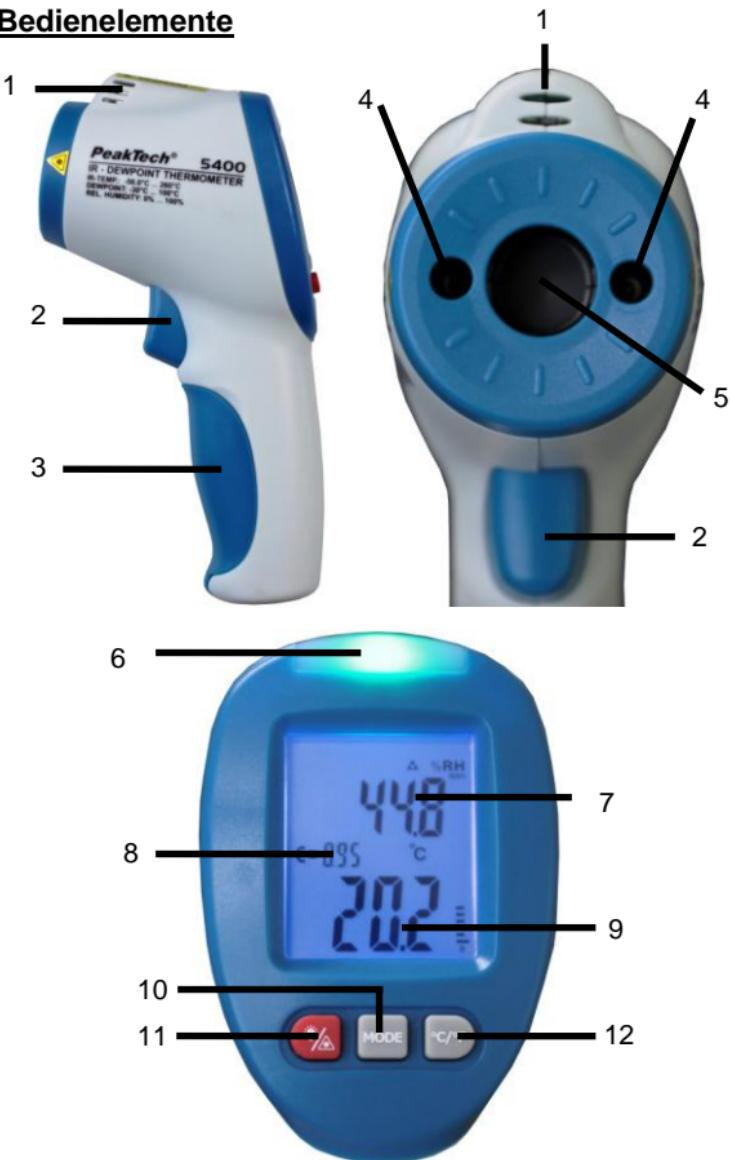
1. Sensor für Lufttemperatur und Luftfeuchtigkeit
