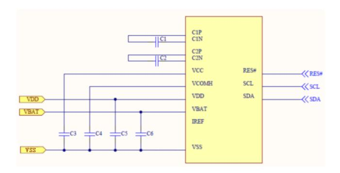
Recommended components : C3, C4 : 2.2uF C5, C6 : 1.0uF C1, C2 : 1.0uF/10V
