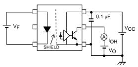
Fig. 13.1.1 I<sub>OH</sub> Test Circuit
