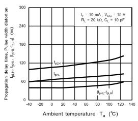
Fig. 13.2.10  $t_{pLH}$ , $t_{pHL}$ , $|t_{pHL}$ - $t_{pLH}|$  -  $T_a$
