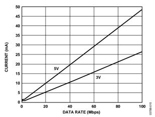
Figure 15. Typical ADuM1402  $V_{\rm DD1}$  or  $V_{\rm DD2}$  Supply Current vs. Data Rate for 5 V and 3 V Operation
